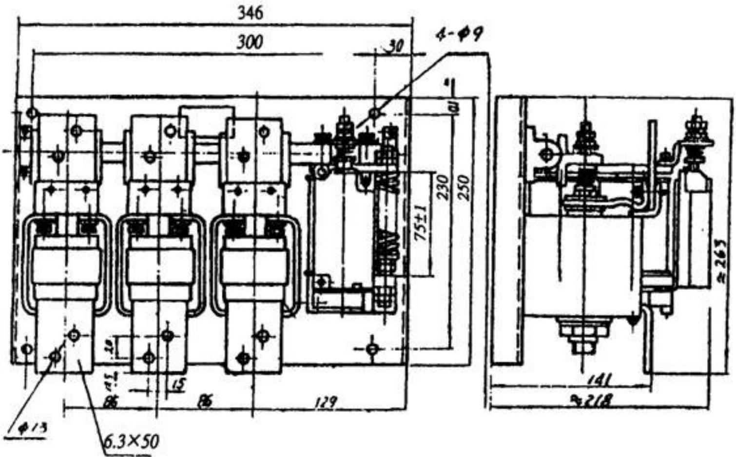
6 CKJ5-630/1.14 接触器外形及安装尺寸图
